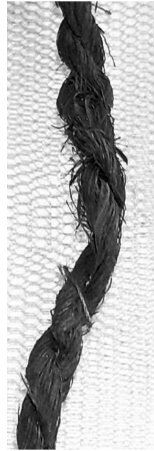
FIGURA 7. Cordón de dos cabos.
